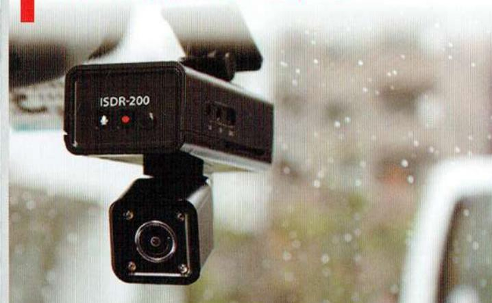
エンジンを掛けると動作を開始し、エンジンが停止するまでの動作中は常に撮影を続けています。撮影中に容量が一杯になった場合にも、**古いファイルから順に削除**をしながら撮影を続けますので、取り逃しの心配がありません。さらに、衝撃を感じた際には専用のフォルダに保存するため、事故の場面などでもしっかりと記録します。
