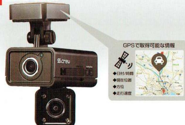
本製品は、**ブラケット(設置台座)にGPSモジュールを内蔵**しています。撮影位置を記録するほか、GPS情報により日時の自動修正をおこなう為、常に**正確な時間が記録**できます。映像とGPSによる各種情報をあわせる事で「いつ・どこで・どのように」衝撃を受けたのかをより正確に把握する事ができます。
